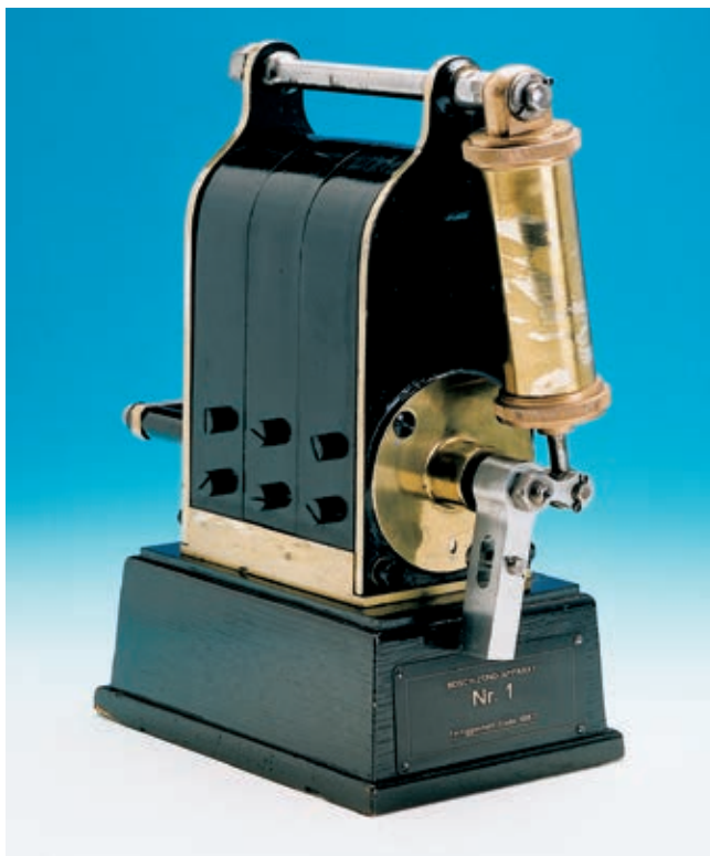
První nízkonapěťový magnetoelektrický zapalovač Bosch z roku 1887. Firma jej získala od zákazníka, když po letech požádal o jeho kontrolu a seřízení...
