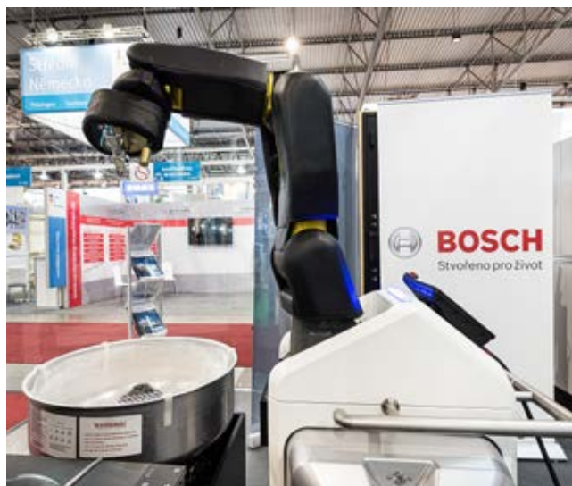
Kolaborativní robot APAS umožňuje práci člověka a stroje bez bezpečnostních klecí a plotů.
