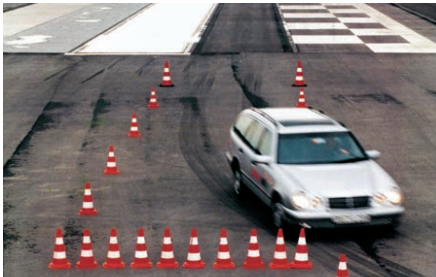
Testování ABS na zkušebním polygonu Bosch v Boxbergu, první ABS (1978).
