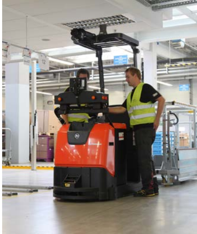
Příklad úspěšného prosazování projektů Průmysl 4.0: automatický stroj na rozvoz a svoz materiálu.
